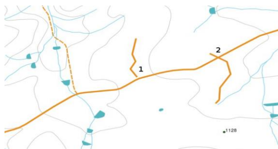
Рисунок 7 – Образец некорректного представления данных в векторной модели
